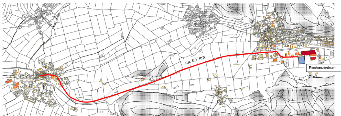
Abbildung 27 Mögliche Verbindungsleitung nach Beringen.
