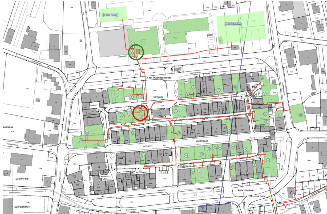
Abbildung 1 Bestehender Verbund Stand 2022. Grün markiert der Holzkesse, rot der Ölkessel (Quelle: E+H Ingenieurbüro)
